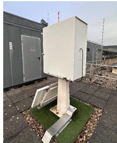
Abbildung 2: Beobachtungsstation mit Einhausung (SFZ Wuppertal)
