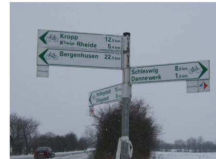
Armwegweiser des Kreisradroutennetzes mit Einschüben für Symbole der Themenrouten
